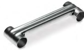
Il manto è realizzato con tubi tondi Ø18 spessore 1.0mm in acciaio zincato elettrosaldati, uniti tra loro da robuste biellette passo 120mm. in acciaio zincato spessore 1.2mm.
