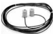
Coppia di sensori per costa optoelettronica. Trasmettitore con cavo da 1,0 m e ricevitore con cavo da 10,5 m. Portata da 1,0 a 8,0 m. Tappi Ø 11 mm
